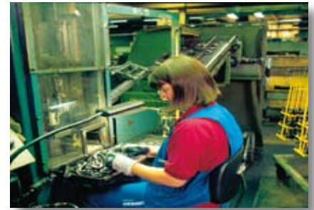
A carga de prova é aplicada em todos os acessórios, além de serem visualmente inspecionados
