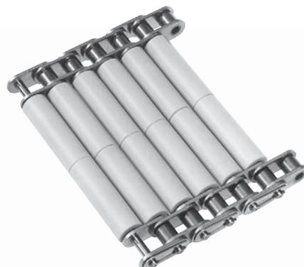
1. Rodas dentadas padrão RS (tipo B) podem ser utilizadas quando o número de dentes for, no mínimo, 15. Quando o número de dentes for menor do que 15, o cubo da roda dentada entrará em contato com a placa dos elos da corrente. Nesse caso, deve-se utilizar rodas dentadas exclusivas para mesas rolantes.
