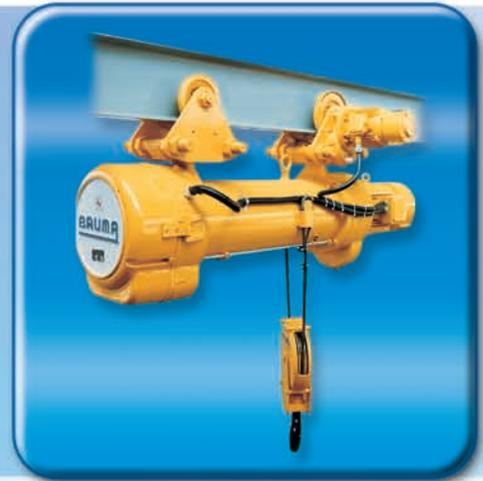
O motor é de rotor em gaiola com freio a disco incorporado, totalmente fechado, com alto momento de partida flangeado na carcaça do redutor.
