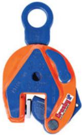
O grampo de elevação vertical IP10 é utilizado para elevar, mover e virar ou para a transferência vertical de placas, chapas ou fabricações da horizontal para a vertical e de baixo para a horizontal (180°), conforme necessário. Geralmente usado como um ponto único de seleção quando utilizado com uma barra espalhadora com linhas de queda verticais múltiplas.
