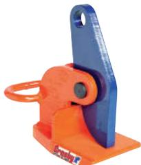
Os grampos de elevação horizontal IPH10E / IPH10JE devem ser usados para elevar e transferir na posição horizontal, materiais ou pacotes de materiais não envergados ou que possam perder firmeza. Estes grampos devem ser usados em pares ou mais.
