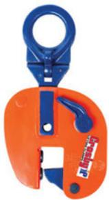
As pega chapas de construção naval IPBUZ são usados para elevação, transferência, colocação dos bulbos na casca do navio perpendicularmente. Estes grampos são acoplados com um dispositivo de trava tanto para as posições abertas quanto fechadas, a qual assegura uma confiabilidade total. Eles devem ser usados exclusivamente para bulbos (não para placas).
