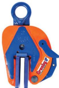
O grampo de elevação vertical IP10 é utilizado para elevar, mover e virar ou para a transferência vertical de placas, chapas ou fabricações da horizontal para a vertical e de baixo para a horizontal (180°), conforme necessário, sem estragar a superfície do material. Materiais como alumínio, aço inoxidável, materiais pintados, partes externas de aeronaves, materiais compostos, vidro, plástico, etc. podem ser elevados sem estragar.
