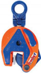
O grampo de elevação vertical IPU10 é utilizado para elevar, mover e virar ou para a transferência vertical de placas, chapas ou fabricações da horizontal para a vertical e de baixo para a horizontal (180°), conforme necessário. O olhal de elevação hinged permite que o grampo coloque e levante a carga a partir de qualquer direção, ou com uma eslinga de várias pernas sem carregar o grampo lateralmente.
